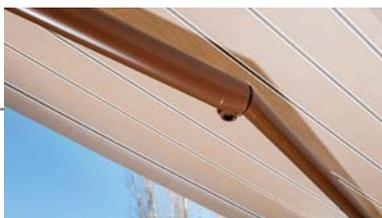
**ROBUSTESSE** La conception des bras des stores Roche Habitat allie une grande robustesse et un design fin sans aspérités à la jonction des composants. Ils sont équipés d'une articulation haute résistance grâce à une bague bronze et des câbles acier surmoulés.
